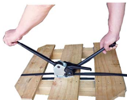
⑤ 帯鉄のシーリングと切断
