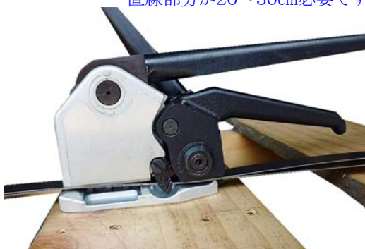
④ 帯鉄のシーリング状態
